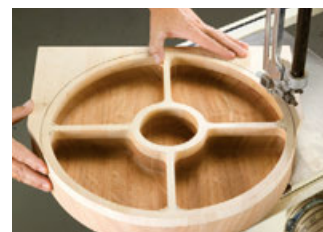
Wytnij zewnętrzny kształt. Gotowe.
