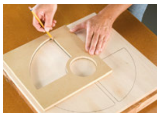
Odrysuj kształt na materiale roboczym, wykorzystując szablony zawarte w zestawie.
