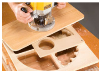
Wykonaj frezowanie wykończeniowe używając dołączonego freza oraz tulei.
