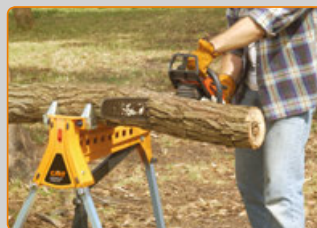
CMT200-01 Szczęki do pniaków i polan, szczególnie przydatne przy pracy piłą łańcuchową
